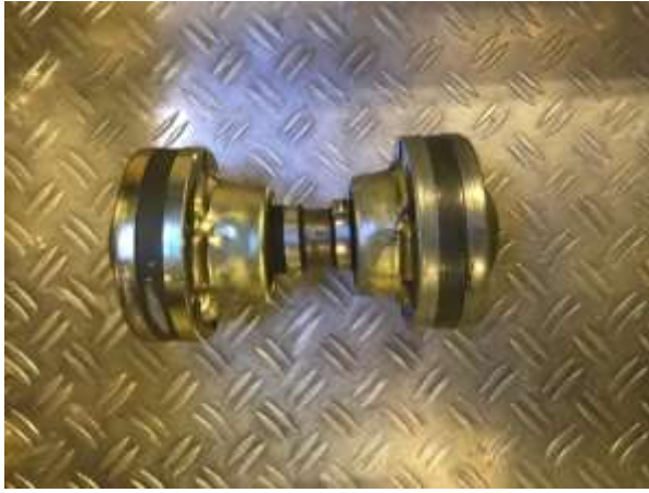
Homokinetische Kupplung Python-Drive alt / neu und wieder eingebaut!
