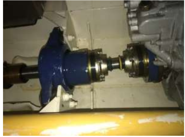
Homokinetische Kupplung Python-Drive alt / neu und wieder eingebaut!
